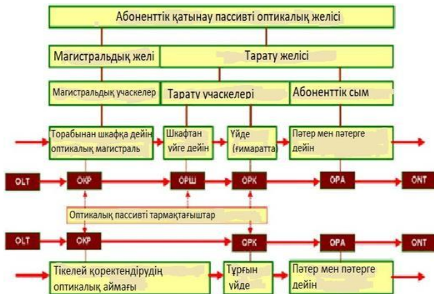
1.3-сурет – GPON технологиясы бойынша абоненттік қатынау желісінің құрылымдық сұлбасы
